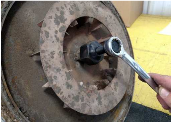
AHS Fan Puller Tool at the Ready
