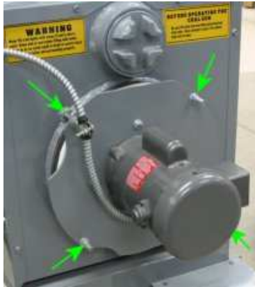
Fan Assembly Mount Points
